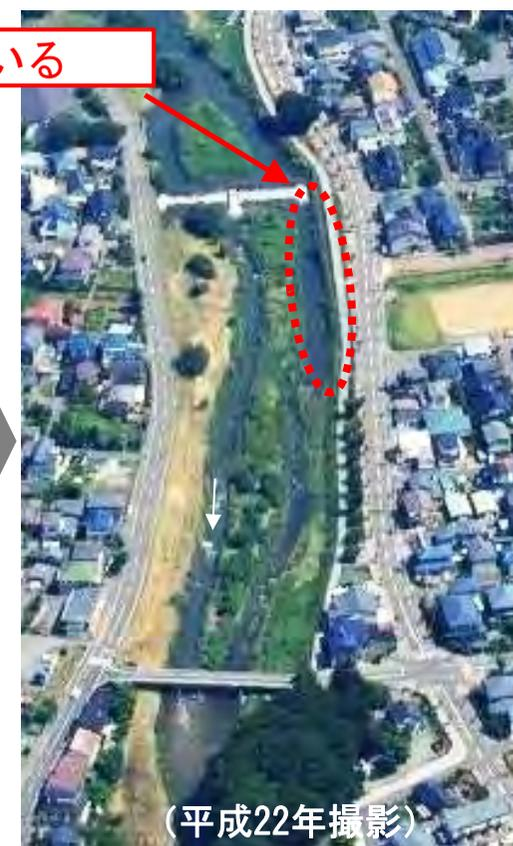
滞筋の堤防接近延長が長くなってきている
